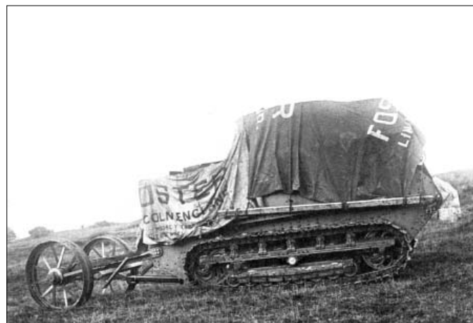
No. 1 Lincoln Machine jako tajna broń przykryta przed oczami niepowołanych osób. Znajdujące się z tyłu małe kółka zostały zamontowane również w „Małym Wilusiu” i służyły do sterowania pojazdem.
