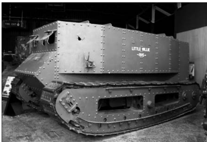
„Mały Wiluś”, eksponowany w Bovington Tank Museum w hrabstwie Dorset, jest to jedna z większych kolekcji w Wielkiej Brytanii. Niestety pojazd został pozbawiony ogona z dwoma kółkami, za pomocą których mógł skręcać.
