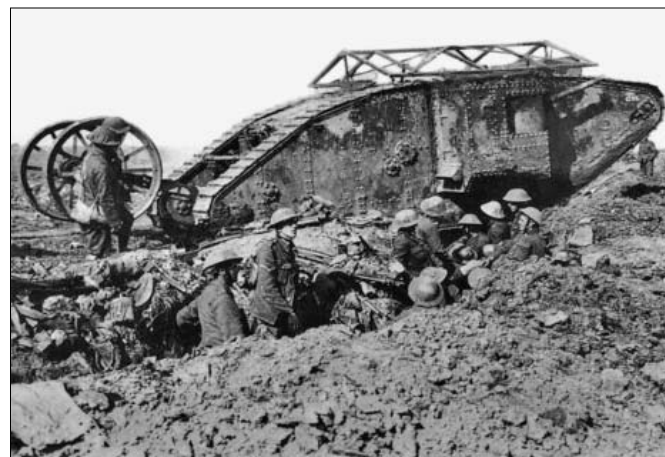
Czołg Mark I na fotografii wykonanej przez znanego fotografa wojennego Ernsta Brooksa w dniu 25 września 1916 r. Pojazd dzięki kształtowi przypominającemu romb mógł dość łatwo pokonywać rowy strzeleckie.
